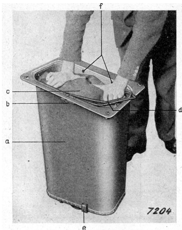
Abb. 10: Einsetzen des Schiebers mit Schlauchboot in den Kasten
